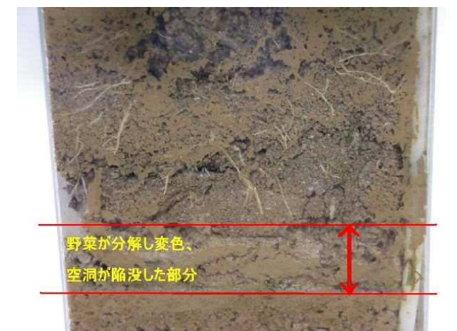
野菜が分解し変色、空洞が陥没した部分
